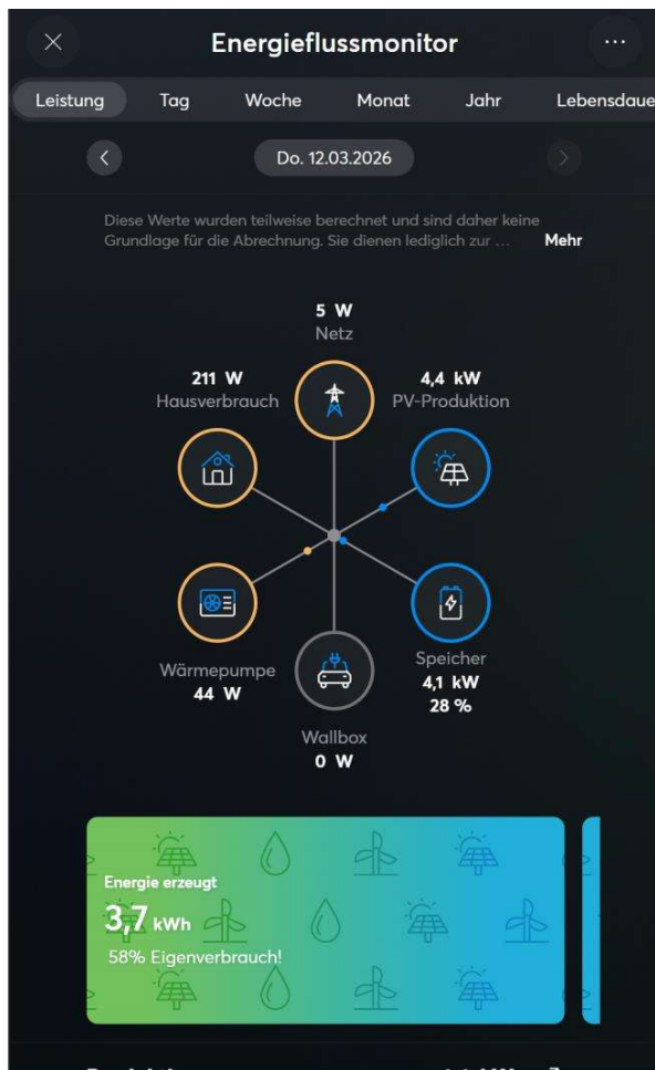
Abb. 7-3: Energieflussmonitor – Live-Übersicht über Erzeugung, Verbrauch, Speicher und Netz
